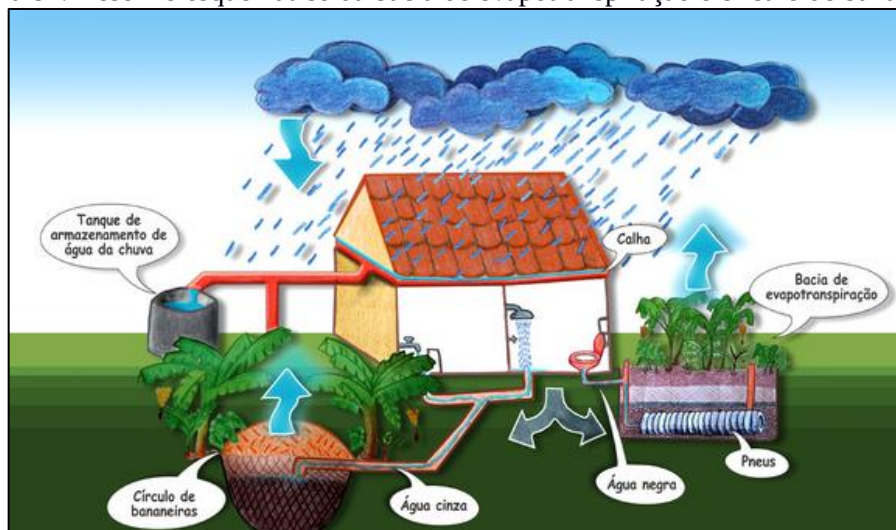
Figura 87. Desenho esquemático da bacia de evapotranspiração e círculo de bananeiras
