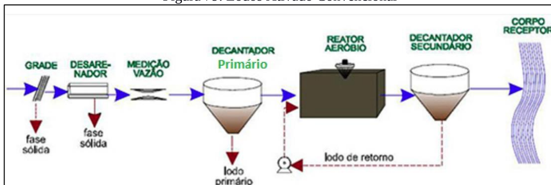
Figura 79. Lodos Ativado Convencional
