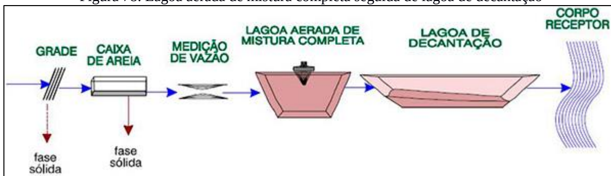
Figura 78. Lagoa aerada de mistura completa seguida de lagoa de decantação
