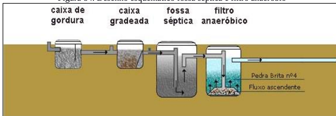
Figura 84. Desenho esquemático fossa séptica e filtro anaeróbio
