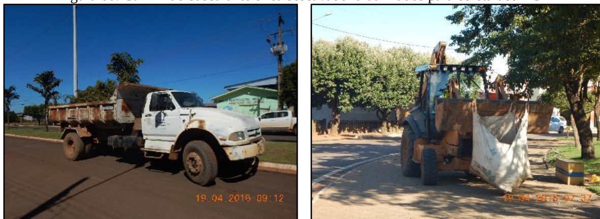
Figura 60. Caminhão basculante e retroescavadeira utilizados para coleta dos RCD
