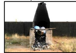
Figura 2116 Incinerador inadequado de RSS
