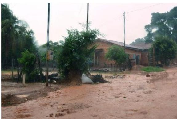
Figura 54 - Alagamento da via devido a ausência de sistema de drenagem
