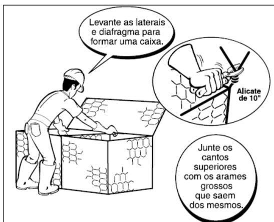
Figura 4.2.3 - Posicionamento dos painéis laterais e diafragmas
