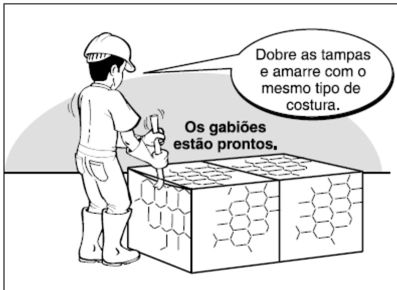
Figura 4.2.10 - Detalhe da etapa de fechamento do gabião tipo caixa
